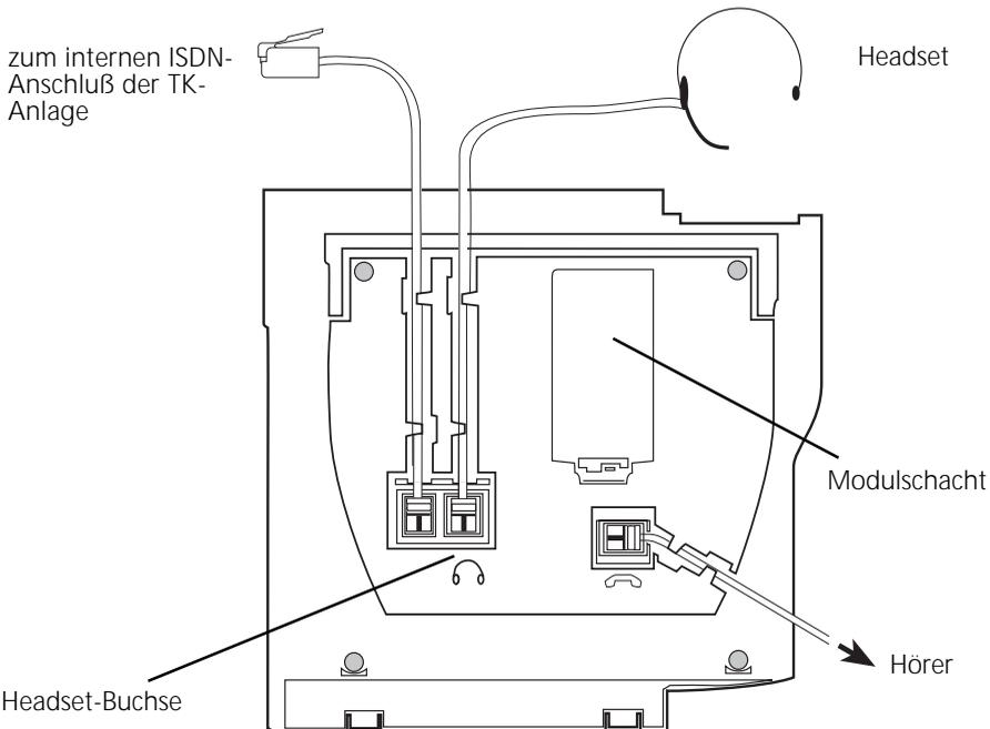
Anschlüsse an der Unterseite des digitalen Mehrwerttelefons ST 30
