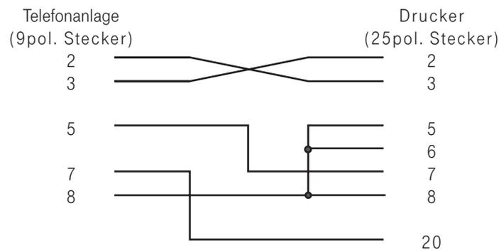
Abb. 5 : Druckerkabel - Anschlußbelegung
