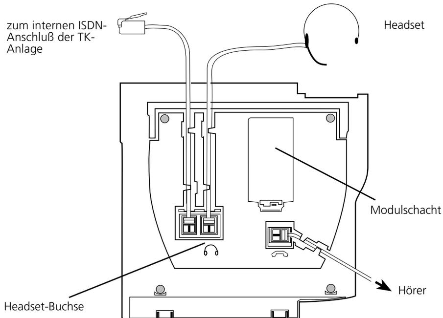
Anschlüsse an der Unterseite des digitalen Mehrwerttelefons ST 30
