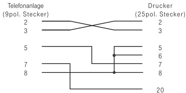
Abb. 15 : Druckerkabel - Anschlußbelegung
