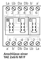
Abb. 3 Anschlußbelegung des Verbindungsmoduls
