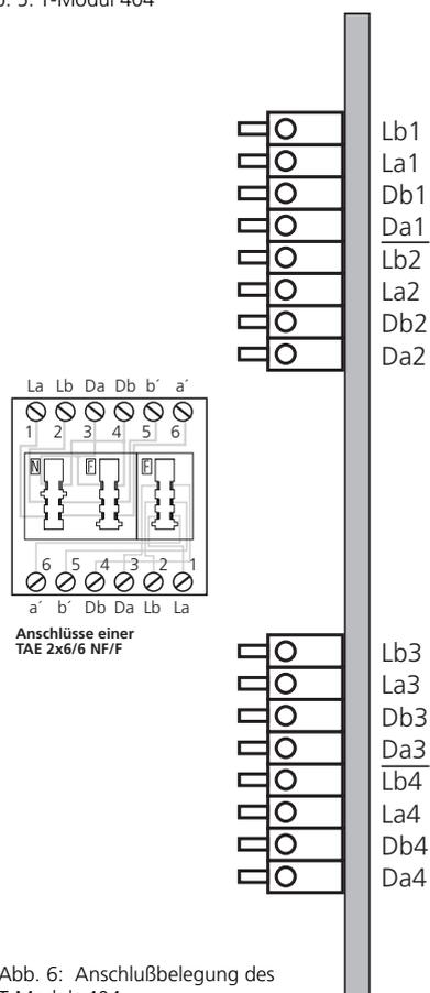
Abb. 6: Anschlußbelegung des T-Moduls 404
