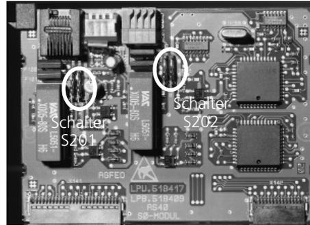
Abb. 9: S0-Modul 420 (LPB 518 409) mit den Abschlußwiderständen
