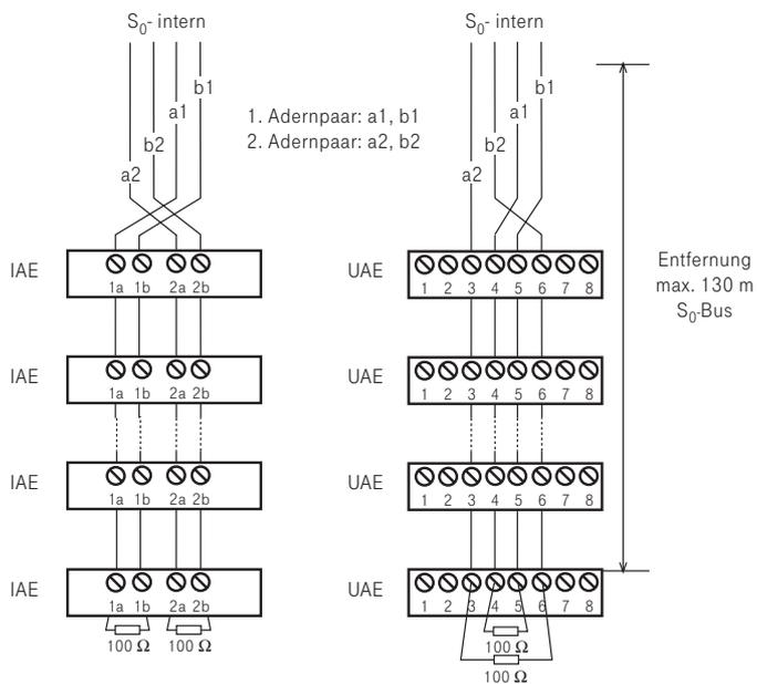
Abb. 11: Verdrahtung eines internen S<sub>0</sub>-Anschlusses
