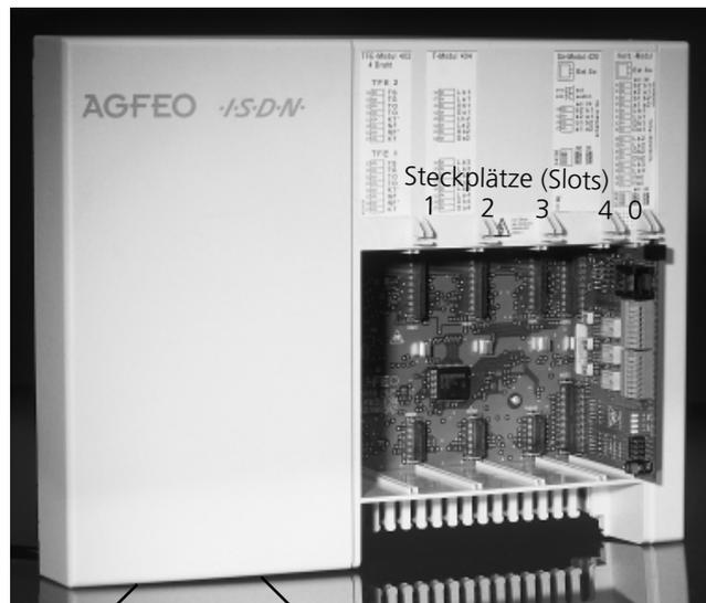
Abb. 1 TK-Anlage mit abgenommenem Deckel
