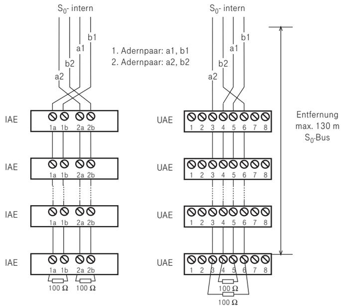
Abb. 4: Verdrahtung eines internen S<sub>0</sub>-Anschlusses
