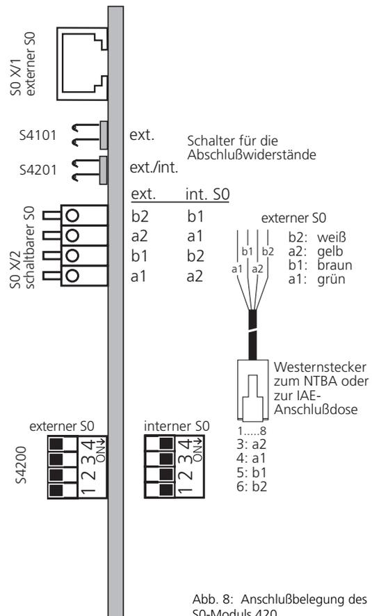
Abb. 8: Anschlußbelegung des S0-Moduls 420
