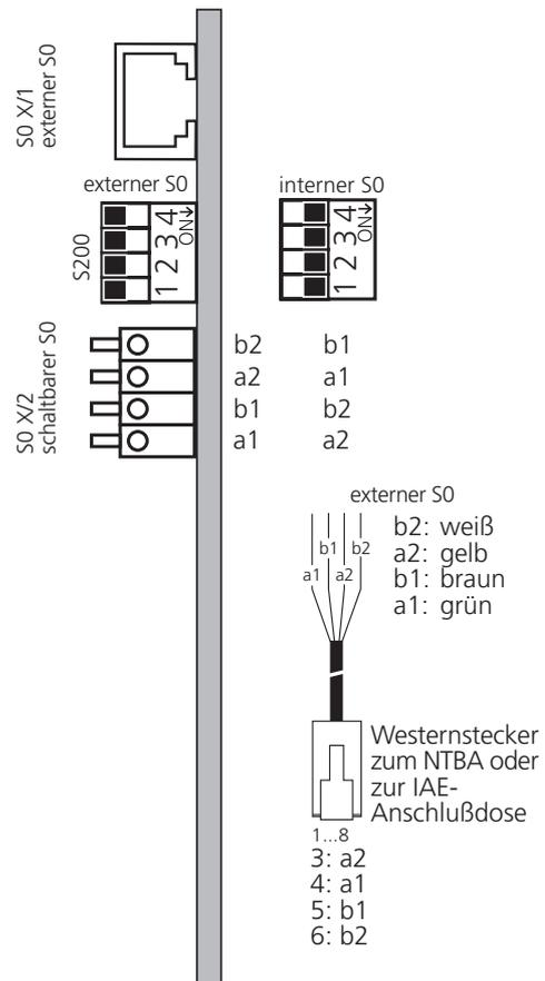
Abb. 10: Anschlußbelegung des S0-Moduls 420 (LPB 518 409)
