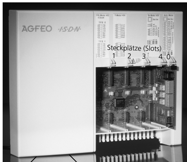
Abb. 1 TK-Anlage mit abgenommenem Deckel
