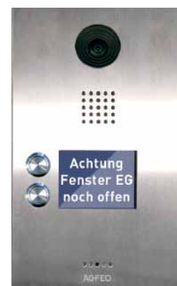
Bild 2: Mit nur wenig Aufwand lässt sich das Display der AGFEO Türfreisprecheinrichtung nutzen, um verschiedene Statusmeldungen anzuzeigen.
