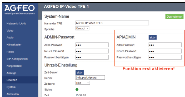
Bild 1: Die http-Befehle sind bei AGFEO durch eine Passwortabfrage vor Fremdzugriff geschützt.
